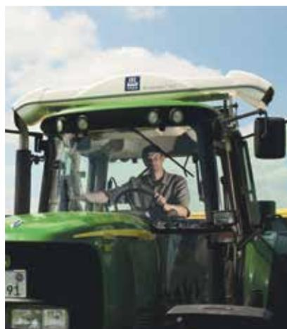
Optischer Stickstoff-Sensor auf dem Dach eines Traktors
