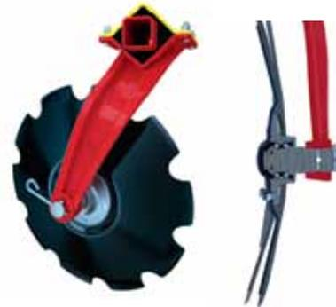
Die MultiSet Naben können in vier verschiedene Neigungswinkel zwischen 10° und 18° verstellt werden. So lässt sich die Bodenbearbeitung in den jeweiligen Bedingungen individuell optimieren. Carrier L und Carrier XL sind mit MultiSet Naben ausgestattet.
