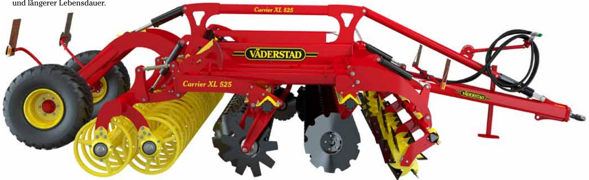
Großes Angebot an Walzen mit wartungsfreien Lagern und neuartiger Gummidämpfung. Der Anstellwinkel der Doppelwalze kann für optimierte Bodenbearbeitung geändert werden.
