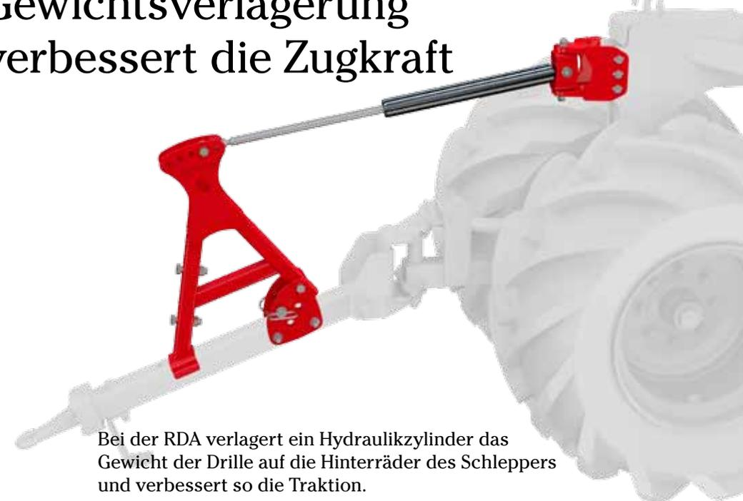
Bei der RDA verlagert ein Hydraulikzylinder das Gewicht der Drille auf die Hinterräder des Schleppers und verbessert so die Traktion.
