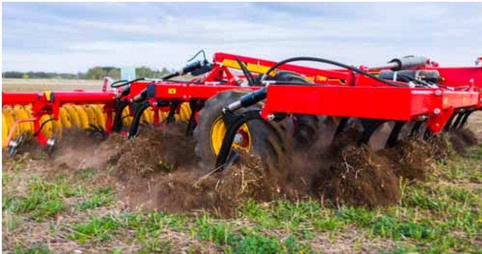
Die hydraulisch geschützten Zinken sind serienmäßig mit geteilten Spitzen und MixIn Leitblechen ausgestattet. Der Anstellwinkel der Zinken wurde so optimiert, dass Klutenbildung so gut wie möglich vermieden wird. Das MixIn Leitblech wirft die Erde nach vorn, so dass Pflanzenreste verteilt und mehrmals mit Erde vermischt und Unebenheiten ausgeglichen werden.
