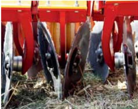
Die X-förmige Anordnung der Scheiben sorgt für weniger Überlappung und hebt die Seitenzugkräfte auf. Das sorgt für stabilen Geradeauslauf hinter dem Schlepper - wichtig bei GPS-Lenkung und ein großer Vorteil an Hanglagen.
