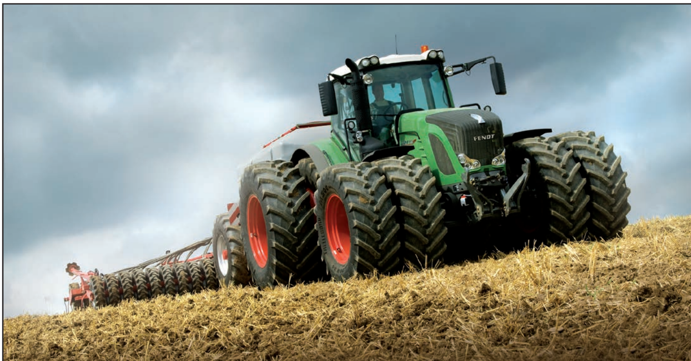
Zwillingsbereifung reduziert den Bodendruck. Quelle: VDMA
