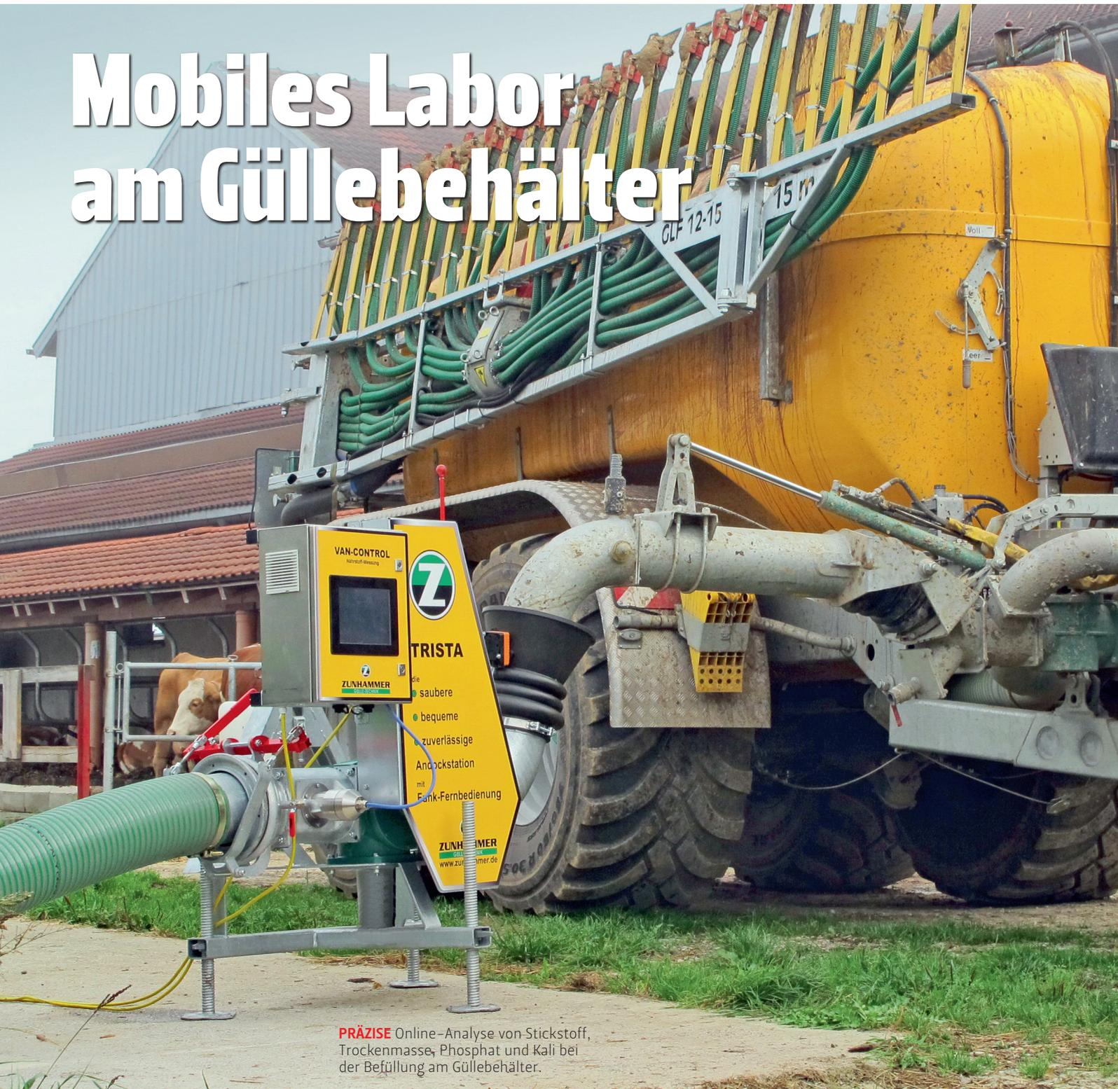
**PRÄZISE** Online-Analyse von Stickstoff, Trockenmasse, Phosphat und Kali bei der Befüllung am Güllebehälter.
