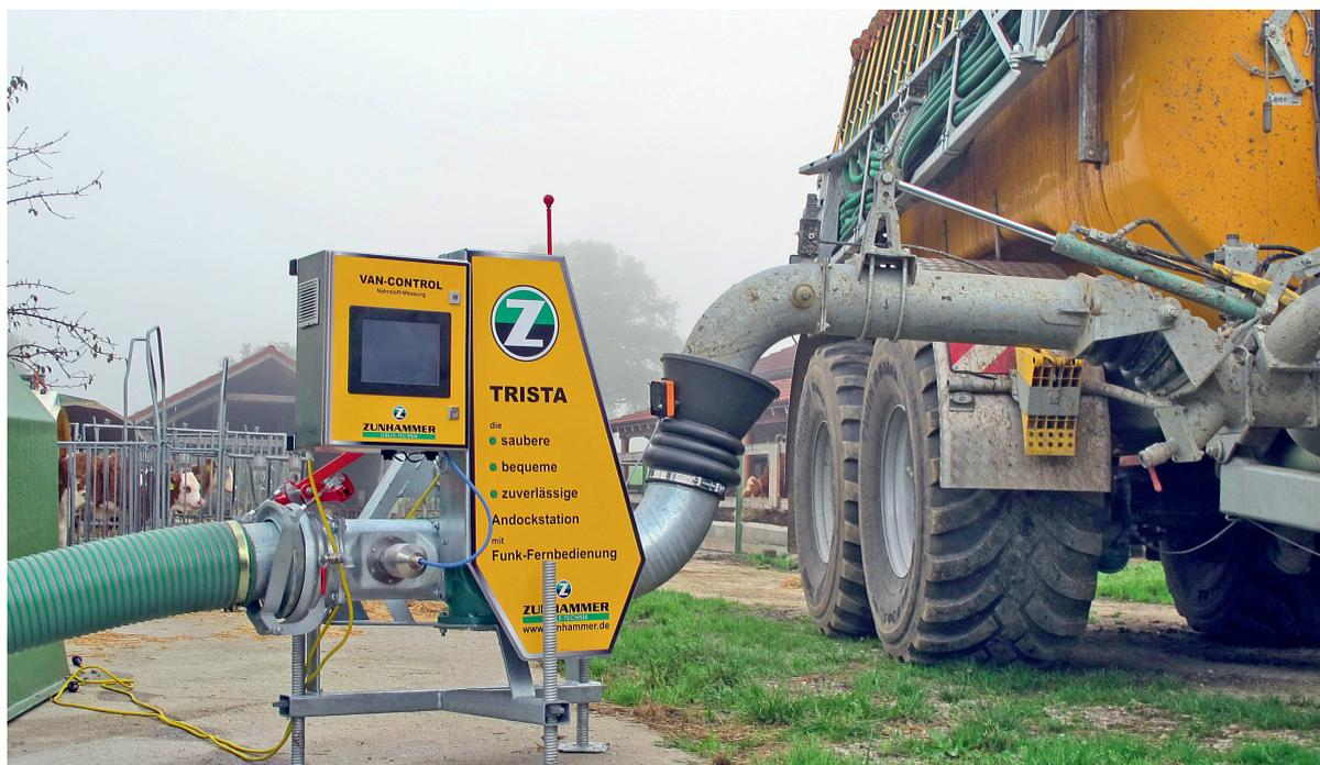
**KOMPAKT** Analyse, Auswertung und Dokumentation sind in einer mobilen Einheit verbaut.
