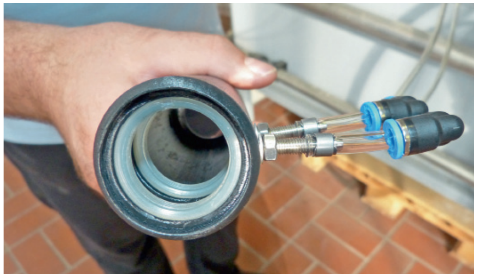
NEUHEIT Die aufblasbaren Ringe im Melkbecherzwischenraum drücken den Zitzengummi bei Druckluftzufuhr gegen die Zitze und bewirken so ein Halten des Melkbechers ohne oder mit sehr geringem Vakuum.
