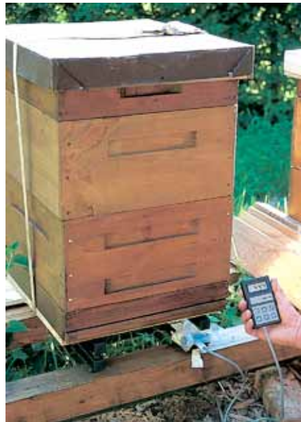
Bei der Zeidler-Memo-Waage von Manfred Raff konnte man bereits 1997 die Daten mit einem Anzeigedisplay oder einem Laptop auslesen.
