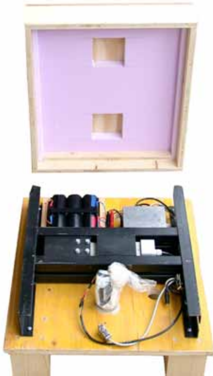
Anfang der 90er Jahre wurden die Prototypen der Capaz-Waagen getestet. Als Sendeeinheit diente ein Handy, das zum Schutz vor Feuchtigkeit einfach in einer Plastiktüte steckte. Foto: J. Schwenkel
