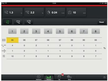
E-CONTROL In spezieller Halterung geschützt kann bei Väderstad ein iPad Air, das kabellos via Wi-Fi mit dem Gateway kommuniziert, zur Steuerung und Überwachung verschiedener Geräte verwendet werden. Hier die Überwachung der Einzelkornablage.
