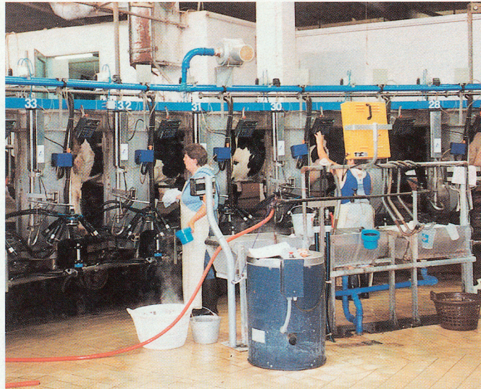
In zwei Melkkarussellen mit 40 Plätzen werden die 2300 Kühe gemolken. Die Melkanlagen wurden von Alfa Laval modernisiert.
