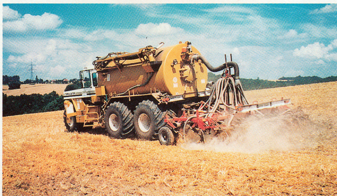
Zwei Terragator mit Grubberinjektor ermöglichen es, die 100.000 m 3 Gülle der eigenen Tiere mit geringem Nährstoffverlust und fast geruchlos einzuarbeiten. Darüber hinaus werden 120.000 m 3 in Lohnarbeit für andere Unternehmen ausgebracht.
