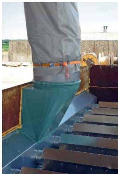
**LUFTVERTEILUNG** In den Anhängern strömt die warme Luft über den Hauptkanal in die Verteilerkanäle.
