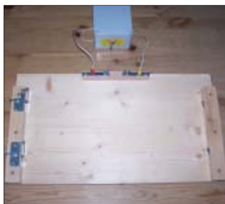
Mit einfachen Mitteln lässt sich die Einlöthilfe selbst bauen.
