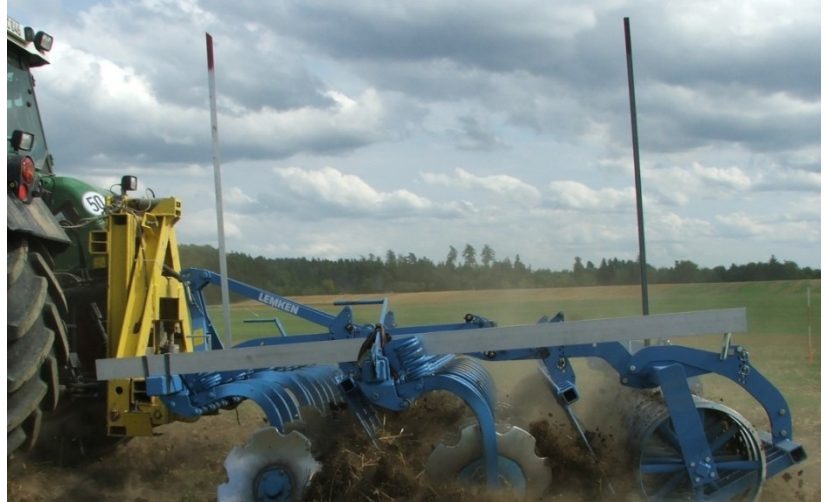
Versuchsfahrt mit falsch eingestellter Kurzscheibenegge: Vordere Scheibenreihe arbeitet ca. 7 cm tiefer als die hintere (Variante A)
