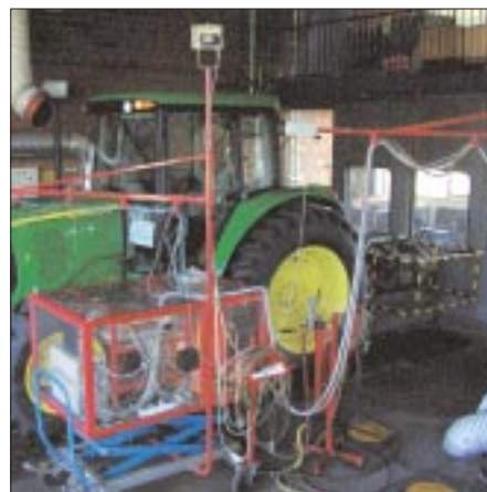
Leistungsmessung am eingebauten Motor
