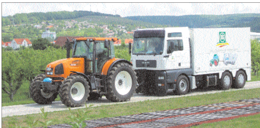
Zugleistungsmessung auf der Prüfbahn der DLG in Groß-Umstadt.
